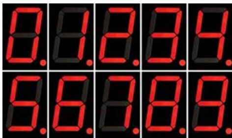
21. ábra BCD elven működő digitális kijelző
